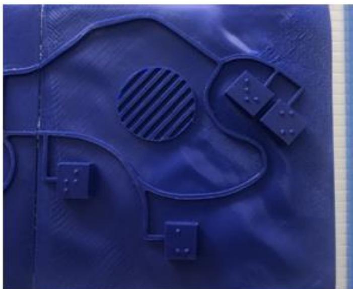
Figura 8. Deformação ocorrida em parte do mapa tátil devido à exposição a alta temperatura.
