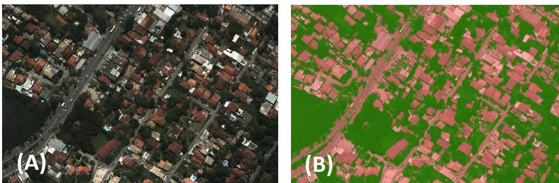
Figura 2. Amostra da mesma área na Ortofoto de 2019 (A) e no resultado da classificação Maxver no software ArcGIS (B).
